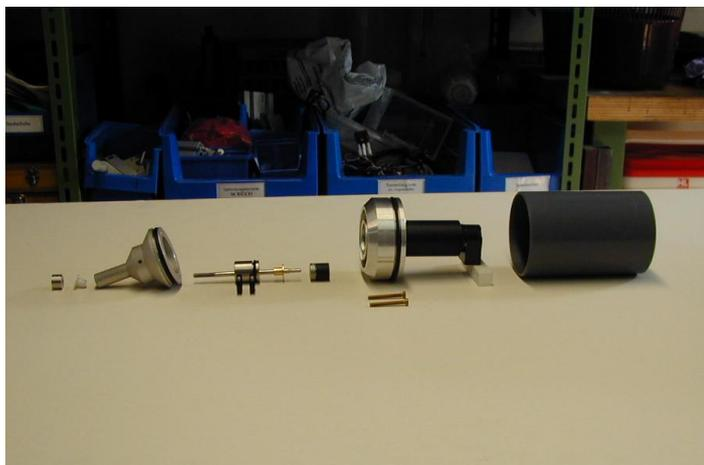
Figura A.7: Montagem do propulsor.
